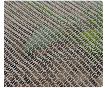
Figure 5. Filet anti-insectes tricoté 'Ornata addu 80100 - mailles 0,8 mm x 1,0 mm
